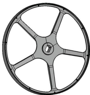
铸铝材料皮带轮原始结构模型
