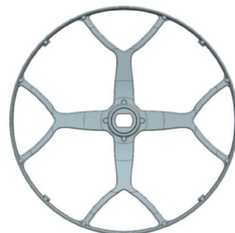
铸铝材料 4 辐皮带轮的优化 CAD 模型
