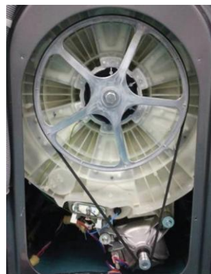
安装在洗衣机上的原铸铝材料皮带轮
