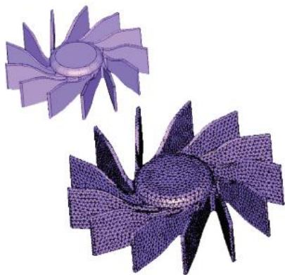
计算机风扇的实体 CFD 网格
